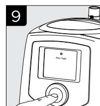
Para iniciar la terapia, pulse rápidamente el SmartDial™ en la pantalla de inicio. La pantalla de inicio se iluminará y la esfera del reloj del sistema de menús girará para indicar que está comenzando la terapia. Si es necesaria la rampa, vuelva a pulsar el SmartDial y manténgalo presionado durante 3 segundos para activarla. Aparecerá el símbolo de la rampa △.
