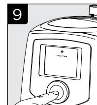
在主屏面上快速按下SmartDial™旋钮将开始治疗。主屏幕将亮起，菜单系统中的时钟面将转动，表示治疗已开始。如果需要延时升压，再次按下SmartDial旋钮并保持3秒钟以激活延时升压。延时升压符号△将显示。
