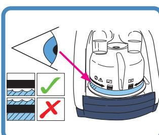
Kiểm tra xem nước có chảy vào ngăn chứa nước và được duy trì dưới vạch mực nước tối đa không. Nếu mực nước tăng lên trên vạch mực nước tối đa, hãy thay thế ngăn chứa nước ngay lập tức.
