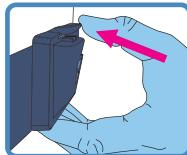
1. Izvadite držač filtra sa stražnje strane uređaja i uklonite filter.
