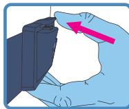
1. Отсоедините фильтродержатель от задней панели устройства и снимите фильтр.
