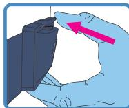
1. Ze zadní části přístroje vyjměte držák filtru a filtr vyndejte.
