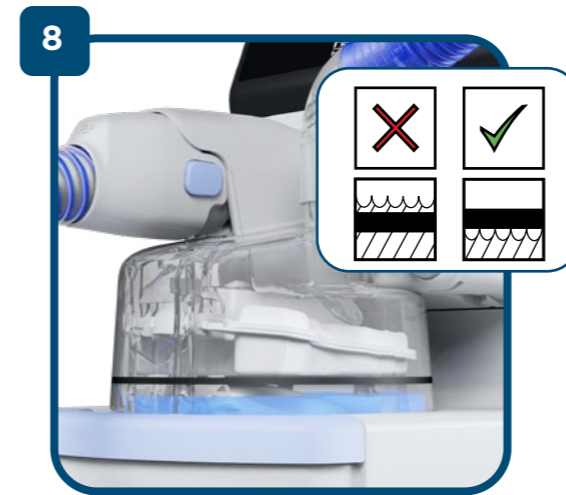
Asegúrese de que el nivel de agua de la cámara de humidificación esté por debajo de la línea de máximo.
