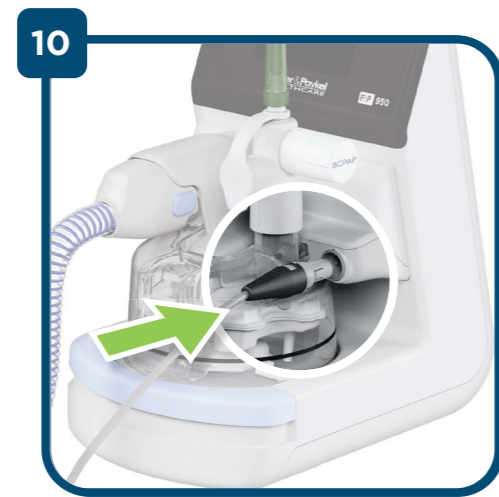
Conecte el adaptador del cable calefactor espiratorio al cartucho del sensor.
