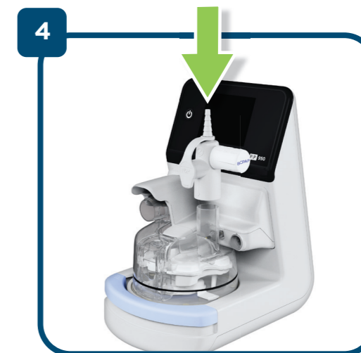
Raccorder le collecteur de limitation de pression BCPAP à la chambre d'humidification.
