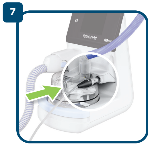
Conecte el adaptador del cable calefactor espiratorio al cartucho del sensor.
