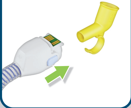
Pour réaliser l'autotest rapide (short self-test, SST), installer l'adaptateur SST entre la branche inspiratoire et le port inspiratoire du ventilateur.
