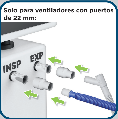
Conecte la línea seca y la vía espiratoria al ventilador utilizando los adaptadores 22F-15F.
