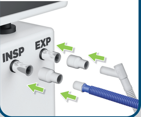
Raccorder la ligne sèche et la branche expiratoire au ventilateur à l'aide des adaptateurs 22F-15F.
