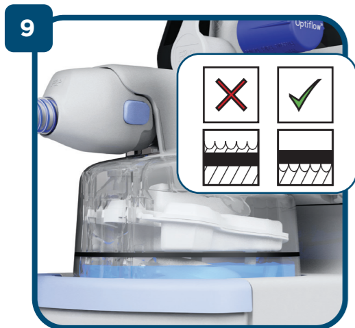
9 Asegúrese que el nivel de agua en la cámara de humidificación esté por debajo de la línea de máximo.
