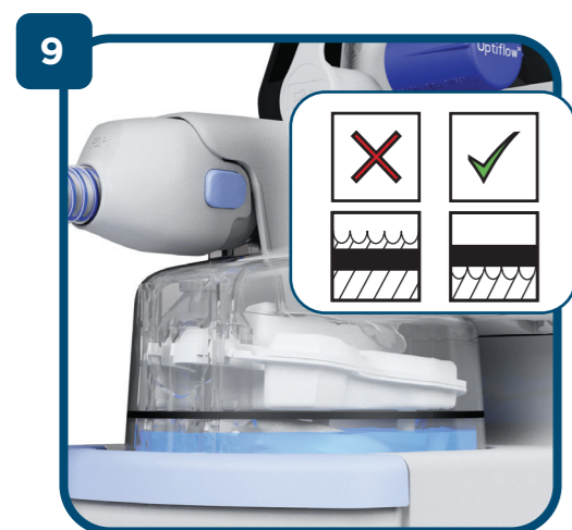
S'assurer que le niveau d'eau dans la chambre d'humidification ne dépasse pas la ligne de niveau maximal.
