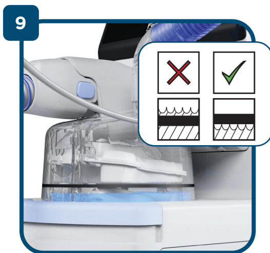
9 Asegúrese de que el nivel de agua de la cámara de humidificación está por debajo de la línea de máximo.
